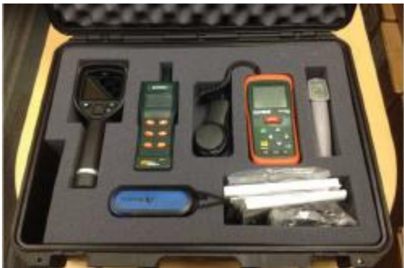
Fot. 1. Zestaw podstawowych przyrządów pomiarowych do oceny parametrów środowiskowych w audytowanych gospodarstwach trzody chlewnej.
